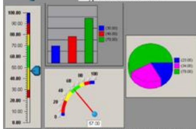
Рисунок 15. Изображение графического элемента «Задатчик уставки» типа «Ползунок» (слева) и изображения графических индикаторов значения аналогового сигнала справа и по центру
