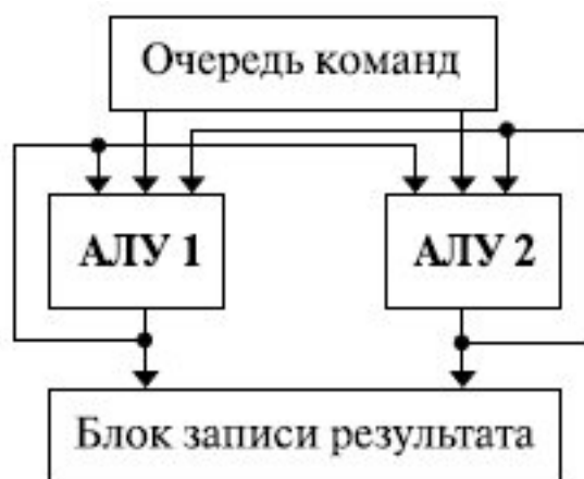
Рис. 9.3. Уменьшение влияния конфликта типа RAW методом продвижения данных
