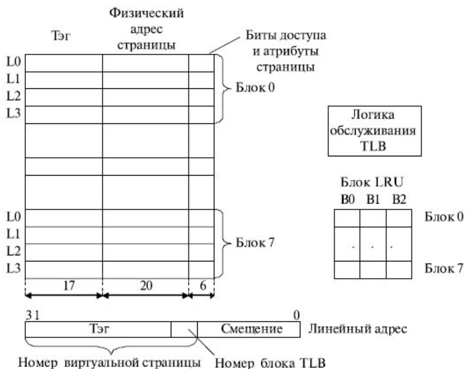
Рис. 3.15. Структура буфера TLB ассоциативной трансляции страничного адреса
