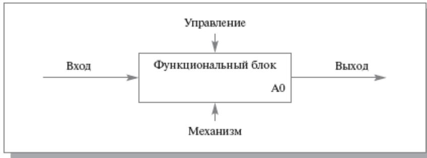
**Рис. 6.1.** Функциональный блок
