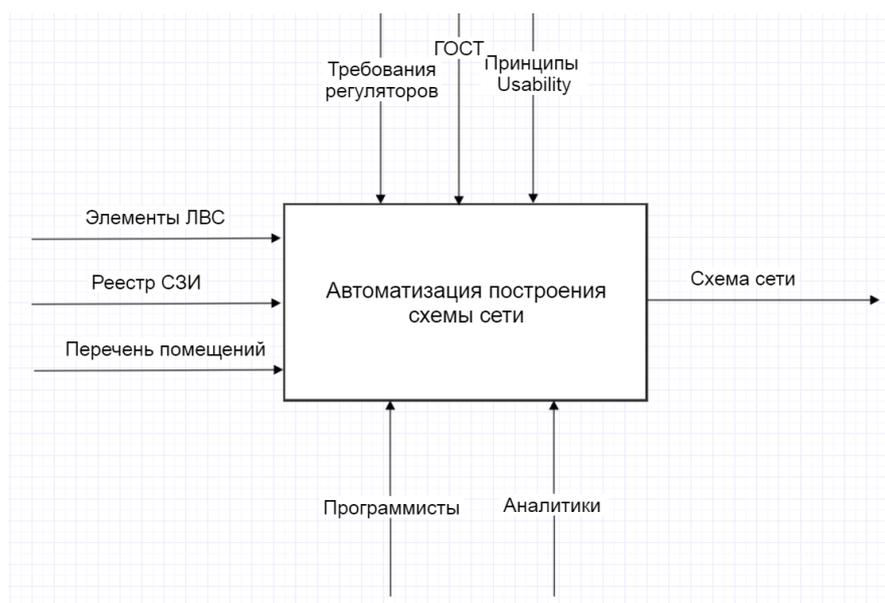
Рисунок 7 – Контекстная диаграмма модели автоматизации построения схемы сети.
