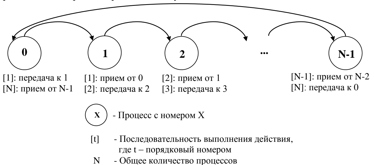
Рис. 1. Схема коммуникации процессов «эстафетная палочка»
